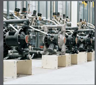
双隔膜泵用于化工厂的流程处理
